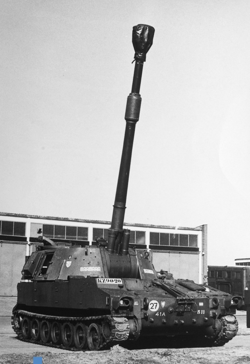
Rechtervoorzijde van het zelf voortbewegend geschut M109A2 155mm houwitser. De vuurbuis met rookafzuiger en afgedekte mondingsrem staat in maximale elevatie (bijna loodrecht omhoog). MIHN-2044_061335
